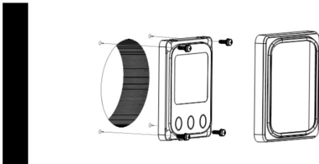
**Etape1:** Localisez et percez des trous de vis en fonction de la taille d'installation de la surface.
