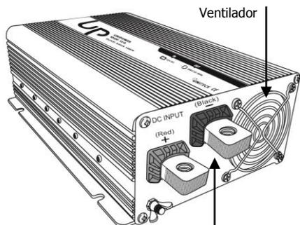
Conexión cable / batería.
