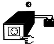
Positionnez l'interrupteur du convertisseur sur ON
