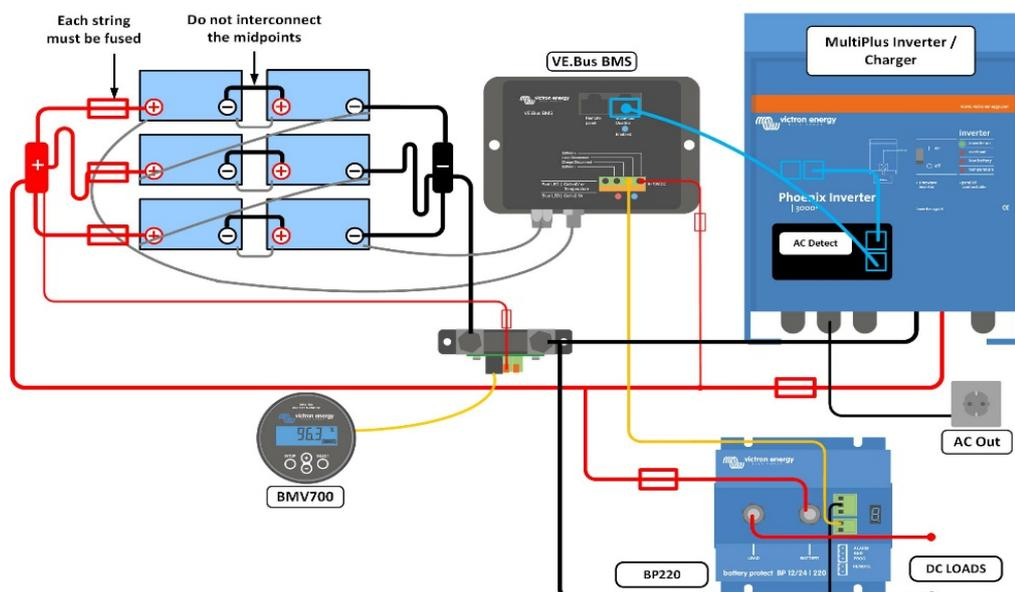
Nos batteries LFP sont équipées de fonctions d'équilibrage et de surveillance de cellules. Jusqu'à 5 batteries peuvent être installées en parallèle et jusqu'à 4 batteries de 12 V ou 2 batteries de 24 V peuvent être connectées en série : ainsi un banc de batterie de 48 V de jusqu'à 1500 Ah peut être assemblé. Les câbles d'équilibrage/surveillance de cellules peuvent être raccordés en série, et ils doivent être connectés à un Système de gestion de batterie (BMS).
