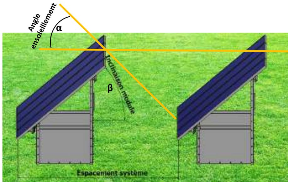
Schéma disposition GROUND SYSTEM
