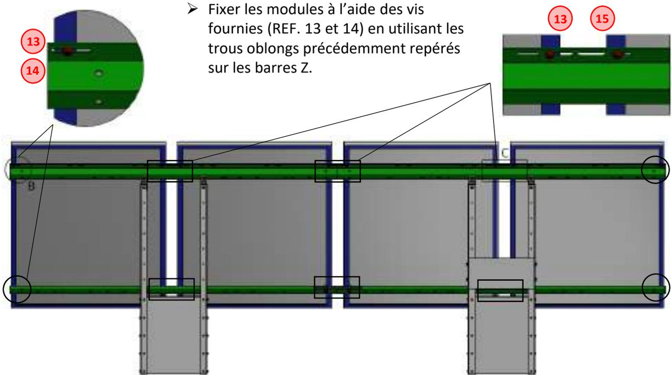
➤ Fixer les modules à l'aide des vis fournies (REF. 13 et 14) en utilisant les trous oblongs précédemment repérés sur les barres Z.
