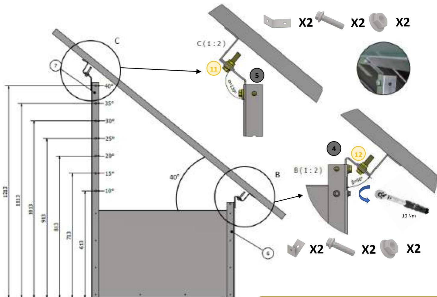
**!** Attention à bien ajuster l'angle des équerres avant et arrière à l'aide d'une pince plate ou d'une plieuse.
