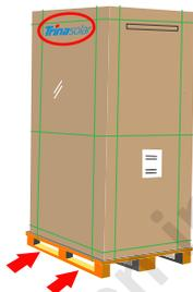
Le chariot élévateur doit être actionné depuis le côté long de la palette (les fourches entrent lentement dans la palette par le côté long). Ne heurtez pas le module. Les deux côtés de la poutre doivent entrer en contact avec le colis en même temps.
