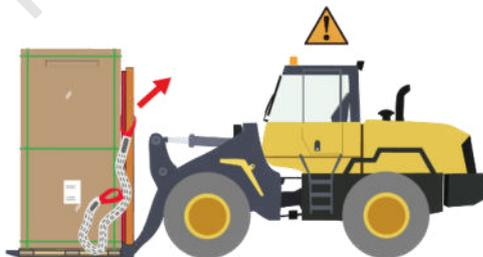
Placer le paquet de modules en douceur sur le sol, détacher la corde de sécurité après confirmation de l'absence de risque de basculement.
