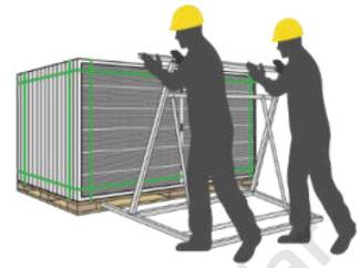
3) Placez le support du support plus haut ou plus large que le module afin d'éviter de heurter et d'endommager la vitre.
