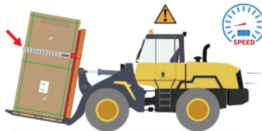
L'ensemble de modules doit s'appuyer sur le dossier, l'ensemble doit être fixé à l'aide d'une corde de sécurité ayant une résistance à la traction  $\geq 2\ 000$  kgf et contrôler la vitesse pour éviter tout renversement.
