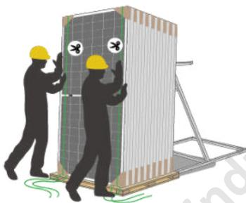
7) Lorsqu'il reste 1 à 2 courroies d'emballage verticales, poussez doucement le module pour l'incliner vers le support du support.
