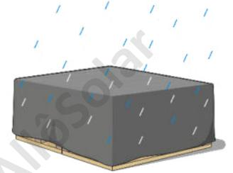
Ne laissez pas les palettes tremper dans l'eau. Les mesures de drainage du sol doivent être prises au préalable pour le site de stockage afin d'éviter qu'une grande quantité d'eau ne s'accumule sur le sol après la pluie, provoquant un ramollissement, un affaissement du sol, etc.
