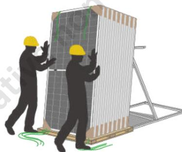
8) Coupez les courroies d'emballage restantes afin que les modules reposent sur le support du support.
