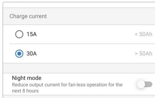
Le chargeur stockera automatiquement le mode de charge sélectionné, et l'utilisera à nouveau pour les prochains cycles de charge (même après avoir été débranché de l'alimentation).
