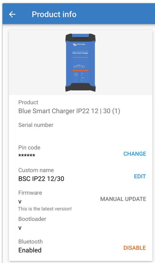
6. Sélectionnez « CHANGE » (à côté de « Code PIN ») pour ouvrir la fenêtre « Modifier le code PIN ».
