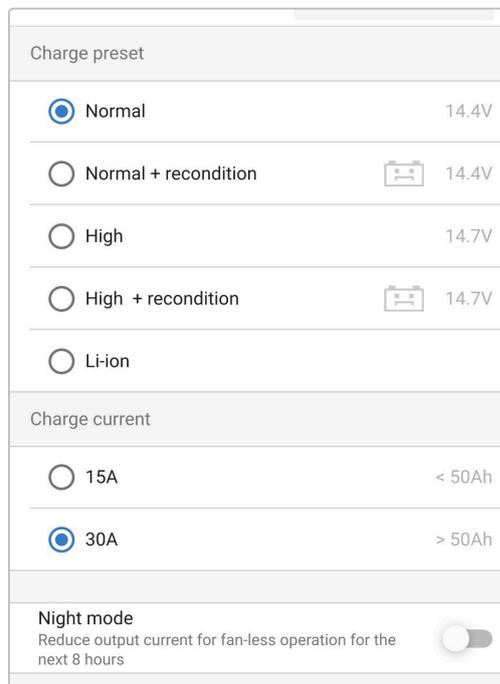
Le chargeur stockera automatiquement le mode de charge sélectionné, et l'utilisera à nouveau pour les prochains cycles de charge (même après avoir été débranché de l'alimentation).
