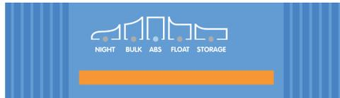
2. Sélectionnez le mode le plus approprié parmi les préréglages de charge intégrés (Normal, Normal + Remise en état, Élevé, Élevé + Remise en état ou Li-ion) en appuyant brièvement sur le bouton MODE du chargeur pour passer d'une option à l'autre ; le voyant situé à côté du mode de charge actuellement sélectionné (NORMAL/HIGH/LI-ION) s'allume, ainsi que le voyant RECONDITION si la phase de remise en état est activée.
