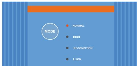
3. Si nécessaire, activez le mode courant faible (courant de charge limité à 50 % du courant de charge nominal maximal et ventilateur désactivé) ; pour activer (ou désactiver) le mode courant faible, maintenez le bouton MODE enfoncé pendant 6 secondes ; lorsqu'il est activé, le voyant NIGHT clignote.
