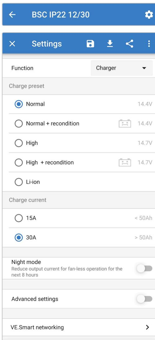
8. Sélectionnez le mode le plus approprié parmi les préréglages de charge intégrés (Normal, Normal + Remise en état, Élevé, Élevé + Remise en état ou Li-ion) dans le menu « Préréglage de charge » ; le voyant situé à côté du mode de charge actuellement sélectionné (NORMAL/HIGH/LI-ION) s'allume, ainsi que le voyant RECONDITION si la phase de remise en état est activée.
